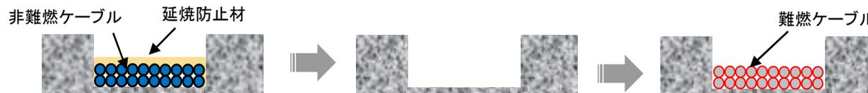
【コンクリートピットのケーブル取替手順イメージ】
